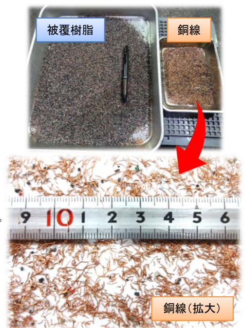
被覆銅線粉砕物からの銅線回収例
